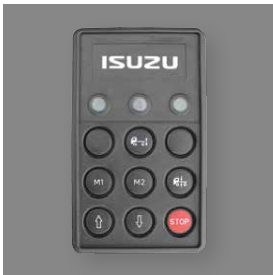
Zdalne sterowanie wysokością zawieszenia pneumatycznego tylnej osi.
